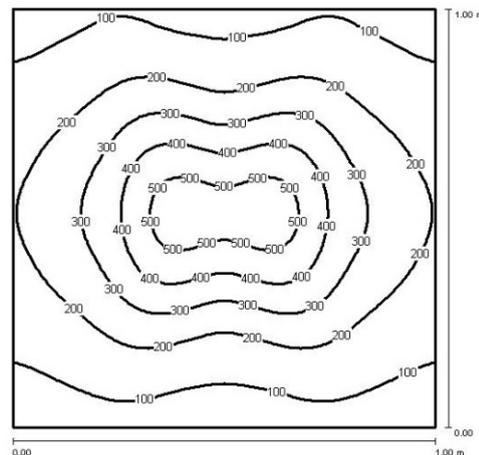
Isoluxdiagramm bei Meßabstand 0,5m,
